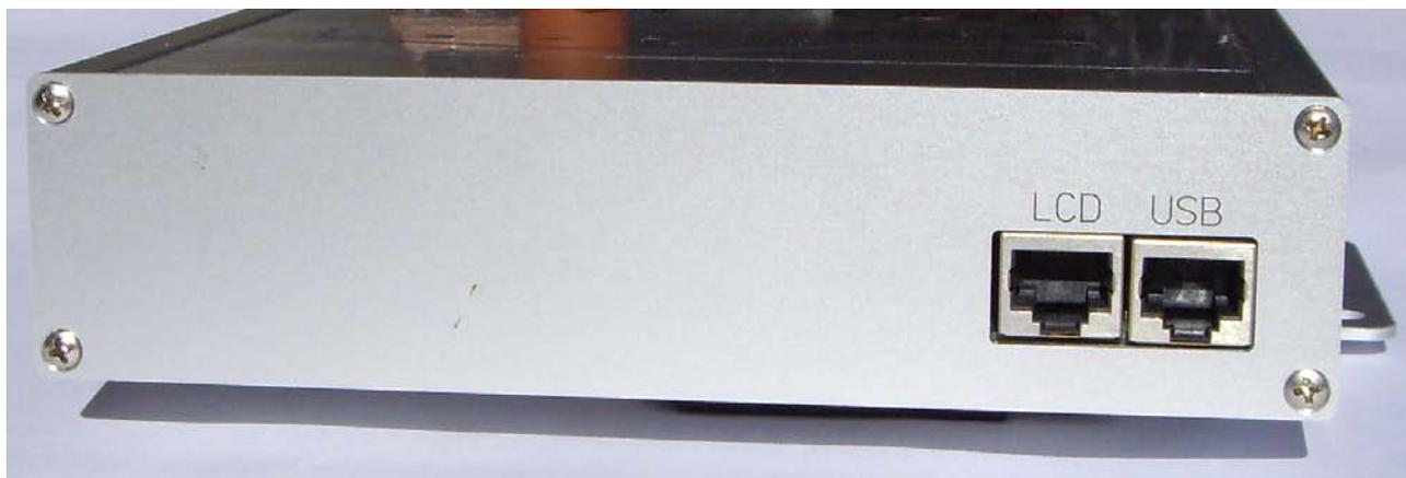
Die Anschlüssen an der Rückseite sind für das optionale 5" / 7" Touchscreen Display und die optionale USB Datenaufzeichnung oder GPS Empfänger.
