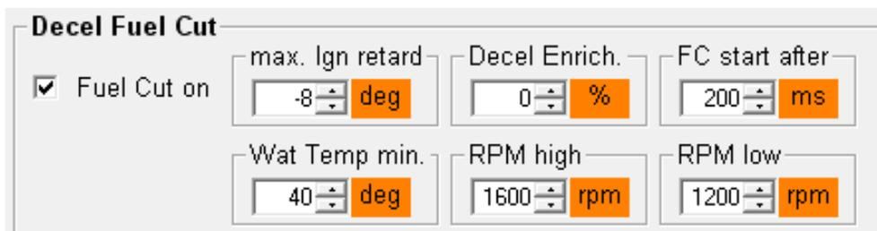
Bei geschlossener Drosselklappe und Motordrehzahlen deutlich über Leerlauf kann die Einspritzung abgeschaltet werden, um Benzin zu sparen. Die Schubabschaltung wird nach schliessen der Drosselklappe aktiviert. Bei raschem Drehzahlabfall wird die Einspritzung vor Erreichen von „RPM low“ wieder automatisch aktiviert.
